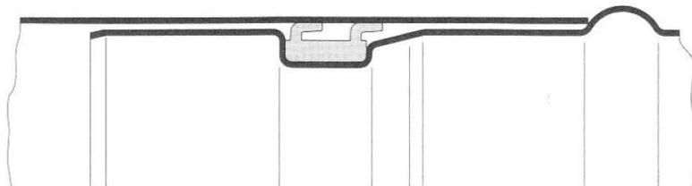
Das Dichtungssystem erfolgt durch einfaches und leichtes Einschieben der Steckenden und durch die in der Dichtungskonzeption vorgegebene Verringerung des Spaltes zwischen Steckende und Rohrwandung.
